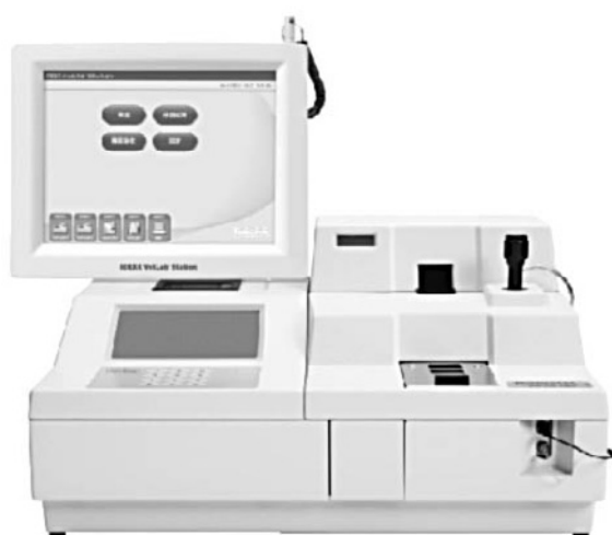
写真 アイデックス ラボラトリーズ(株)製 ペットテストおよびスナプリーダー 21種類の血液化学検査が可能なペットテスト(血液化学検査 器)に、スナプリーダー(内分泌検査器)を取り付けることで、 犬および猫のT4、犬の血中コルチゾールの測定が院内で実施 できる
