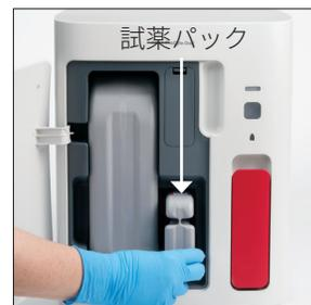
シースパックの**交換**：検査器の内側から大きい灰色のシースパックを引き出します。次に、新しいシースパックをカチッという音がするまで奥に差し込みます。
