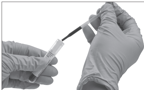
図4-9: 3.2%クエン酸ナトリウム入り真空チューブからサンプルを採取する
