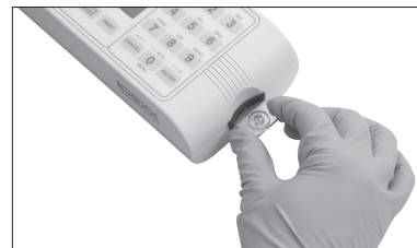
図4 - 8: コアグDx クエン酸PTカートリッジまたはクエン酸aPTTカートリッジをセットする
