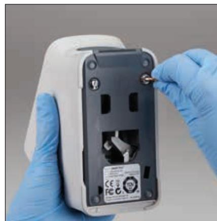
7. 銀色の留め具を時計回りに4分の1回転させ、底面をロックします。
