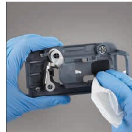
4. 糸くずの出ない布または綿棒に70%のイソプロピルアルコール、中性洗剤および水、または10%漂白剤溶液を少し含ませて底面**全体**を清掃します。
