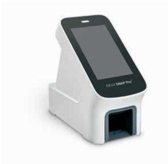
糸くずの出ない布に70%のイソプロピルアルコール、中性洗剤、水、または10%漂白剤溶液を少し含ませてケースとタッチスクリーンを清掃します。
