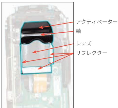
5. 糸くずの出ない布または綿棒に70%のイソプロピルアルコール、中性洗剤および水、または10%漂白剤溶液を少し含ませて3つの白色リフレクター、軸およびアクティベーターを清掃します。**レンズは清掃しないでください。**
