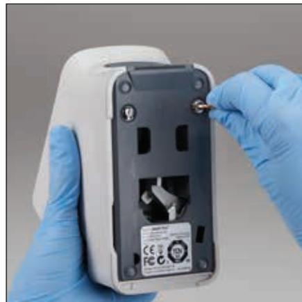
2. 検査器の底にある、2つの銀色の留め具をマイナスドライバーなどを使用し、反時計回りに4分の1回転します。
