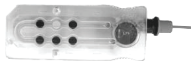
図14。シリンジアダプター付ベットスタートカセット、1 mL シリンジ
