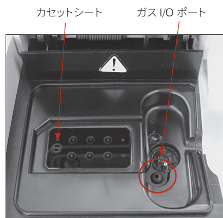
図27. サンプル測定チャンバー (SMC) の内側
